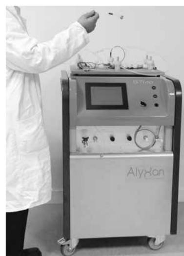
spécifique a ainsi été développé, permettant l'injection des composés désorbés par le TDFlash dans l'analyseur BTrap. Grâce à l'enrichissement de l'échantillon, les limites de détection atteignent la sub-ppb. », souligne Noëlle PENNOBER. « Nous travaillons aujourd'hui dans la même optique sur le couplage d'un pré-concentrateur en ligne et du spectromètre BTrap »
